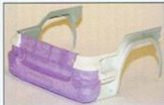
Nach ausreichender Trocknung wird die weiße Farbe abgedeckt und es erfolgt der nächste Auftrag mit Blau.
