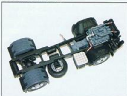
Kompletierter Fahrzeugrahmen mit seinen Anbauteilen mit Blick von oben.
