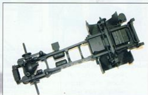
Kompletierter Rahmen mit eingebauter Vorderachse und Kotflügelabdeckungen.
