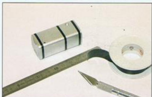
Neue Haltebänder für den Treibstofftank aus schwarzem Isolierband.
