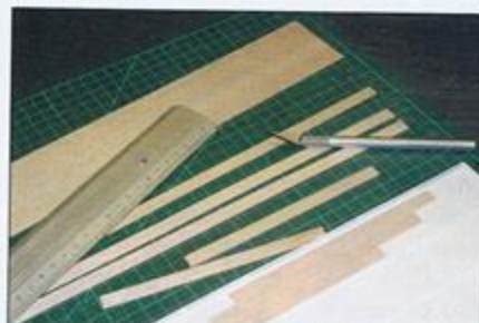
Zuschnitt der Holzbeplankung auf der Oberseite des Trailers.
