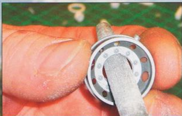
Schnitt- und Sägekanten werden mittels einer Feile gesäubert.
