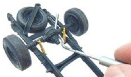
7 Hier ist etwas Fummelarbeit gefragt: Zuerst wird das hintere Stück mit Schalldämpfer unter der Hinterachse eingefädelt
