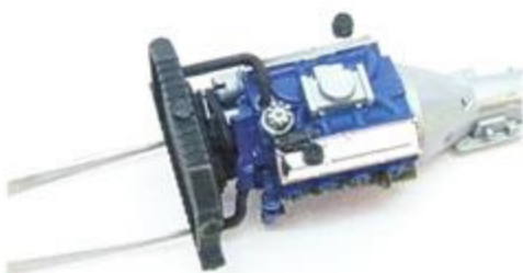
4 Passprobe vor dem Verkleben – sicher ist sicher. Der Kühler wird mit den Schläuchen am Motor montiert; alles passt Out-of-Box
