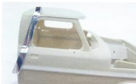
11 Am Original-Pickup finden sich Chromleisten. Alternativ zur Bemalung sind sie am Modell mit Bare Metal Foil dargestellt
