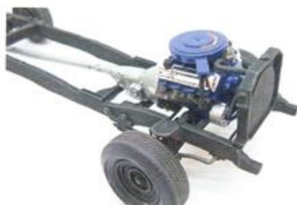
5 Gleiches gilt für die Montage der kompletten Motoreinheit mit Getriebe am Rahmen. Auch die Kardanwelle sitzt, wie sie soll
