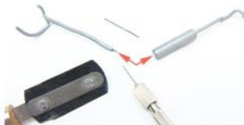
6 Die Montage der Auspuffanlage vereinfacht sich deutlich, zerlegt man das Bauteil in zwei Einzelteile und verstiftet diese danach
