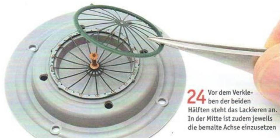
**24** Vor dem Verkleben der beiden Hälften steht das Lackieren an. In der Mitte ist zudem jeweils die bemalte Achse einzusetzen
