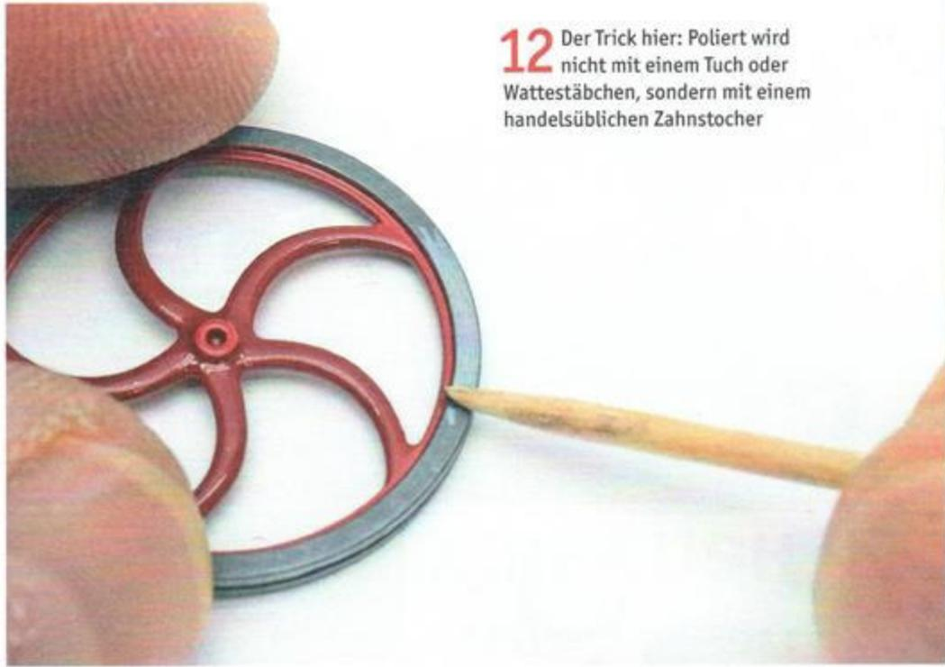
**12** Der Trick hier: Poliert wird nicht mit einem Tuch oder Wattestäbchen, sondern mit einem handelsüblichen Zahnstocher
