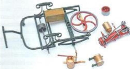
**2** Kleines Manko im Bausatz: Am Anfang steht das Verputzen und Schleifen der Teile, die alle eine sichtbare Naht tragen
