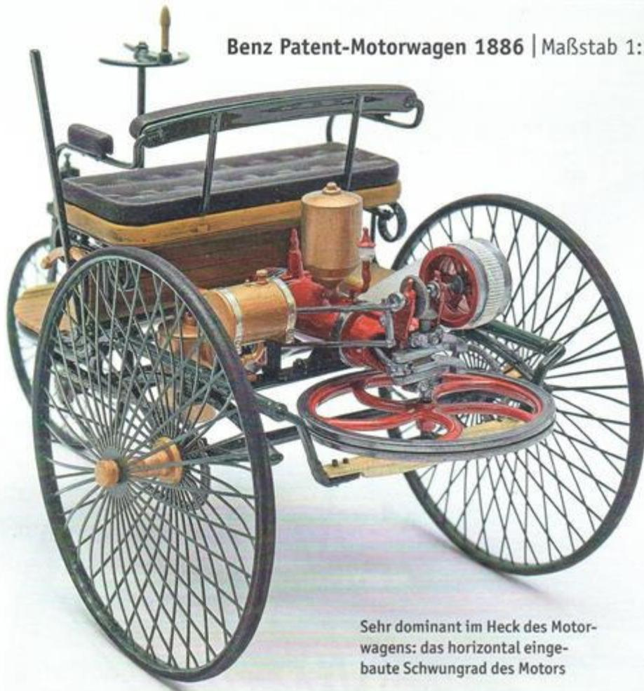
Sehr dominant im Heck des Motorwagens: das horizontal eingebaute Schwungrad des Motors
