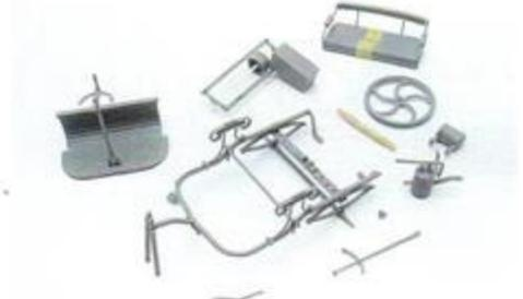
**6** Die Achse der Riemenräder ist erneuert (oben Mitte). Der Riemen fehlt noch, alles ist fertig für die anstehende Bemalung
